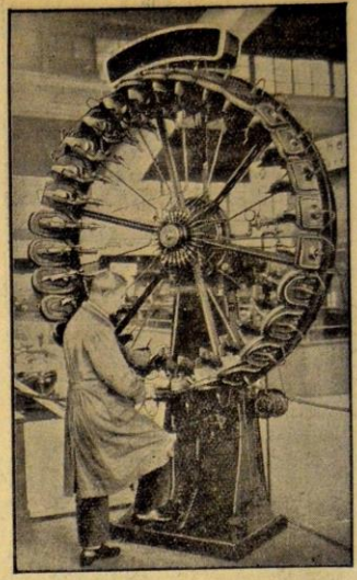
Dieses Bild zeigt einen interessanten Apparat der Schau, und zwar eine Sohlenanstrichpresse, wie sie in Schuhfabriken Anwendung findet.
